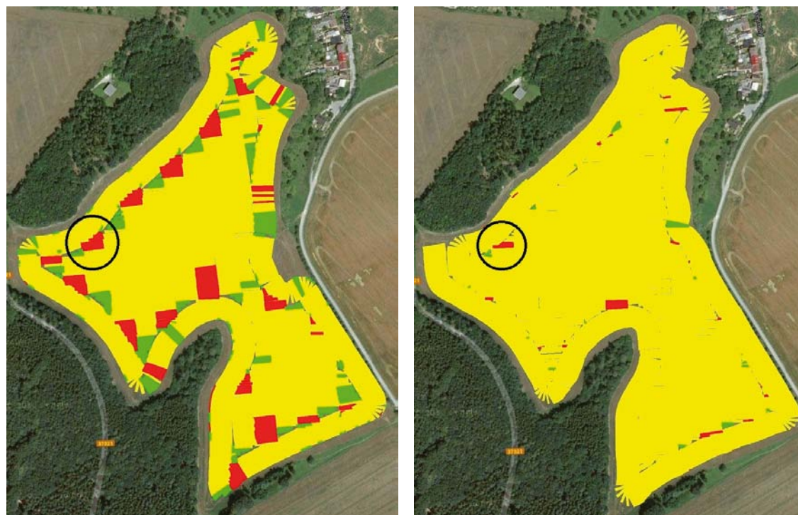
Obr. 2 a 3 – Regulace DynamicFluid4 podobně jako vzduchová asistence TWIN dovede ušetřit mnoho peněz. Vlevo standardní „rovnoměrnost“ dávky, vpravo rovnoměrnost s regulací DynamicFluid4. Červené plochy jsou ošetřeny dávkou nižší než 70% požadované dávky, zelené dávkou nad 130% požadované dávky
