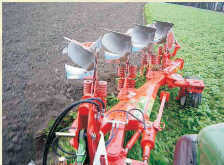
Nesený otočný pluh JUPITER II 120 4P čtyřradličný s pružinovým NON-STOP jištěním orebních těles
