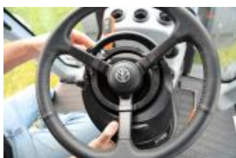
montáž prstencového převodu
