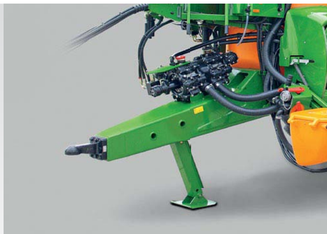
Oj hitch, pevná, s hydraulickým pohonem čerpadla
